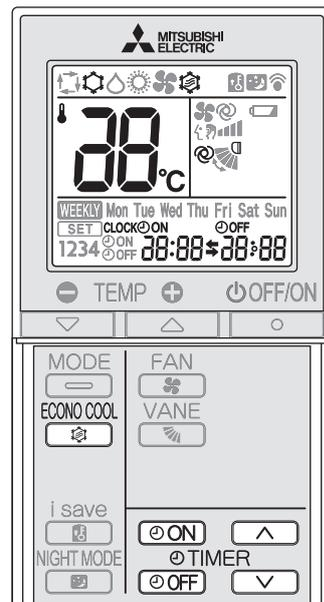
Изменяемое направление воздушного потока дает ощущение большей прохлады по сравнению с постоянным потоком. Заданная температура и направление воздушного потока изменяются автоматически микропроцессором управления. Можно выполнять операцию охлаждения воздуха, поддерживая при этом комфортный режим. Таким образом можно экономить электроэнергию.
