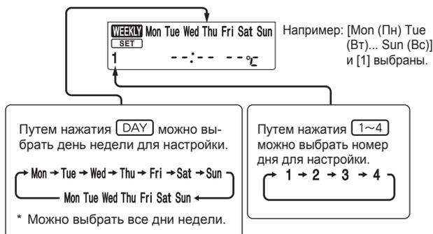
**3** Нажмите **[ON/OFF]**, **[TIME]** и **[TEMP]**, чтобы задать ON/OFF (ВКЛЮЧЕНИЕ/ВЫКЛЮЧЕНИЕ), время и температуру.
