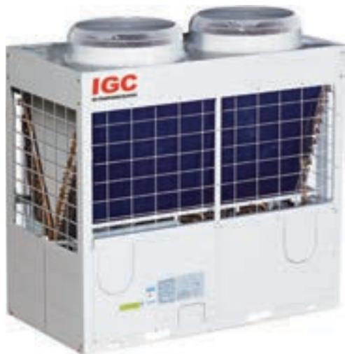
Модульные чиллеры серии T, тропического исполнения представлены моделями производительностью 180, 250 кВт, построены на основе спиральных компрессоров Copeland, оснащены испарителями «труба в трубе» или кожухотрубного типа (в зависимости от мощности чиллера) и имеют воздушное охлаждение конденсатора. Модульный принцип исполнения позволяет построить систему холодопроизводительностью до 2000 кВт, при этом работа нескольких чиллеров в модуле осуществляется в режиме «ведущий/ведомый».
