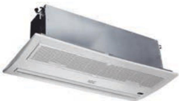
Встроенная дренажная помпа с высотой подъема конденсата до 700мм от поддона. Корпус блока имеет специальное теплоизолирующее покрытие, предотвращающее образование конденсата на поверхности. Фильтр-сетка используется в течение всего срока эксплуатации фанкойла. Возможность подключения притока свежего воздуха.
