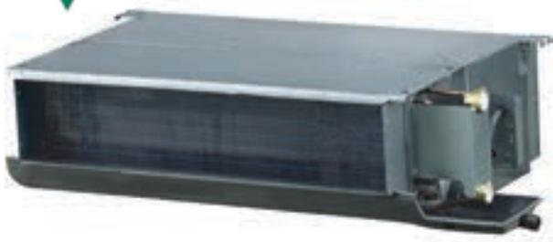
Двухтрубные каналные фанкойлы IGC представлены моделями производительностью от 2 до 12,5 кВт, с двух- или трехрядными теплообменниками и внешним статическим давлением 30 или 50 Па. Поставляются в комплекте с дренажным поддоном, разработанным с учетом подключения 3-ходового клапана к фанкойлу (клапан в комплект не входит) и быстросъемным воздушным противопылевым фильтром класса G2. Корпус выполнен из стали с гальваническим покрытием, хорошо противостоящим коррозии.
