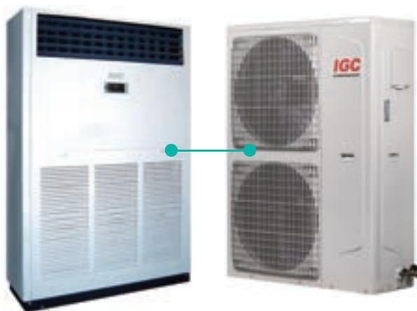
Инверторные колонные полупромышленные сплит-системы большой мощности (96 кВт) IGC идеально подходят для открытых помещений большой площади и объема (например, выставочные залы или помещения автомобильных салонов). Сильный поток охлажденного воздуха, направленный от внутреннего блока вверх, отражается от потолка и равномерно распределяется по всему помещению. Инверторная технология регулирования производительности позволяет точно поддерживать необходимые температурные условия.
