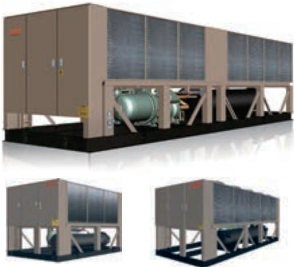
Высокоэффективный чиллер с двухвинтовым полугерметичным компрессором Bitzer (Германия)/ Hanbell (Тайвань) подходит для использования в качестве системы центрального кондиционирования, промышленной системы холодоснабжения. В зависимости от тепловой нагрузки на чиллер загрузка компрессора осуществляется ступенчато на 25, 50, 75 или 100%. Возможен заказ опциональной системы плавного регулирования в диапазоне 50 – 100%.
