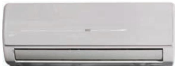
Двухтрубные настенные фанкойлы IGC представлены моделями производительностью от 2.63 до 5 кВт. Поставляются в комплекте с воздушным противопылевым воздушным фильтром класса G2, беспроводным пультом управления, дренажным поддоном. Трехходовой клапан встроен в корпус фанкойла.
