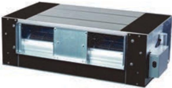
Двухтрубные каналные высоконапорные фанкойлы IGC представлены моделями производительностью от 6.6 до 19.9 кВт, с трехрядными теплообменниками и внешним статическим давлением 70 или 100 Па. Поставляются в комплекте с дренажным поддоном и воздушным противопылевым фильтром класса G2. Корпус выполнен из стали с гальваническим покрытием, хорошо противостоящим коррозии.
