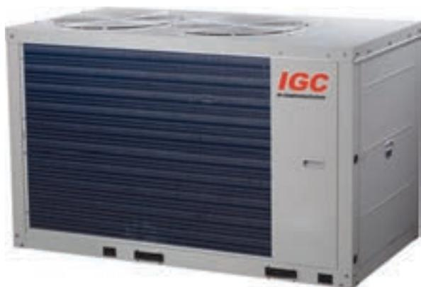
НОВАЯ СЕРИЯ модульных полностью инверторных чиллеров серии Q представлена моделями производительностью от 27.6 до 82 кВт. Чиллеры оснащены испарителями пластинчатого типа и имеют воздушное охлаждение конденсатора. Модульный принцип исполнения позволяет построить систему холодопроизводительностью до 1312 кВт (объединив 16 чиллеров в модуль).
