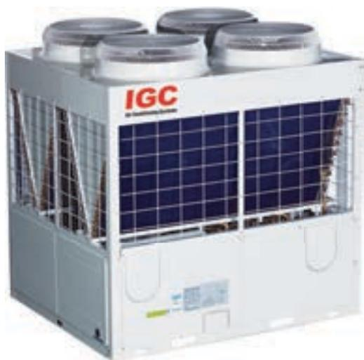
Модульные чиллеры серии Т представлены моделями производительностью 185, 250 кВт, построены на основе спиральных компрессоров Danfoss и Copeland, оснащены испарителями «труба в трубе» или кожухотрубного типа (в зависимости от мощности чиллера) и имеют воздушное охлаждение конденсатора. Модульный принцип исполнения позволяет построить систему холодопроизводительностью до 2000 кВт, при этом работа нескольких чиллеров в модуле осуществляется в режиме «ведущий/ведомый».
