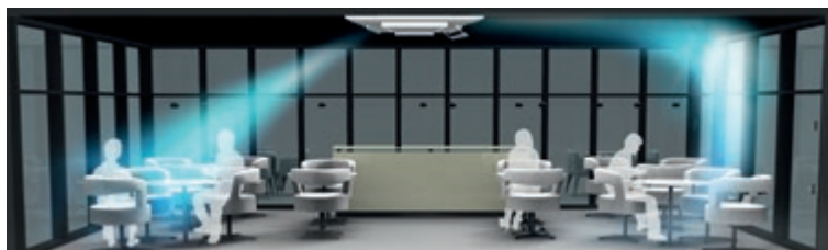
Направление воздушного потока панели по предотвращению сквозняков
