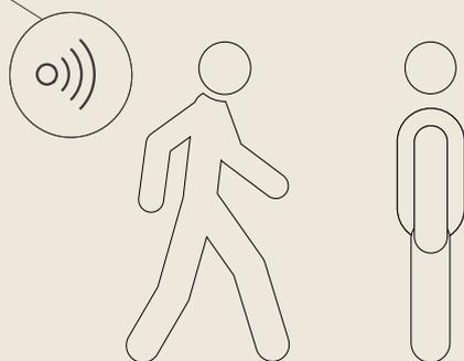
Датчик присутствия Eco Sensor постоянно контролирует наличие людей в помещении. Если в течение 20 мин. кондиционер не обнаруживает людей — уставка изменяется на 1 °С; через 40 мин. уставка изменяется еще на 1 °С.
