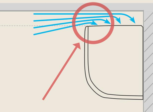
При близком расположении к потолку внутреннего блока обычной стандартной конструкции создается область турбулентности и высокого сопротивления, что мешает воздуху из помещения свободно поступать во внутренний блок, что приводит к повышению шума во время работы, снижению энергоэффективности и нестабильной работе кондиционера. Поэтому для внутренних блоков обычной формы стандартное рекомендованное расстояние до потолка составляет 150–200 мм.
