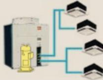
Первая в мире VRF-система на базе спиральных компрессоров с инверторным приводом
