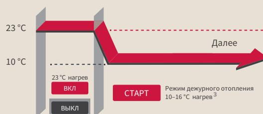
1. По истечении количества дней, заданных для функции «Дежурного отопления», кондиционер автоматически переключается в прежний режим работы.
