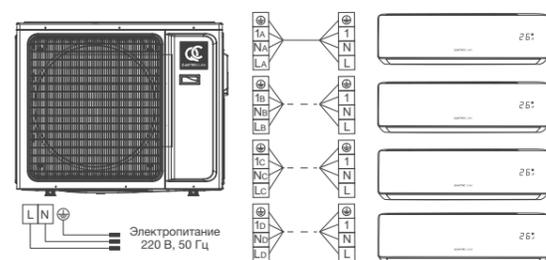
Электрическая схема подключения
