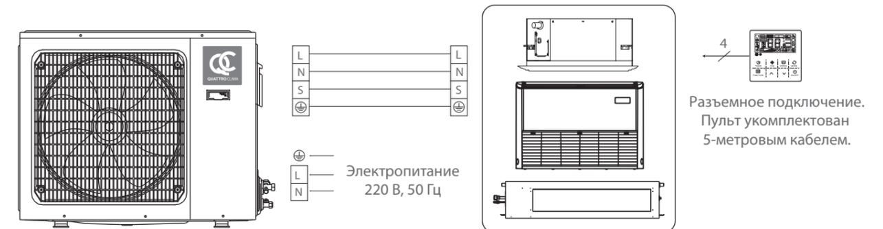
Электрическая схема QV-I48...60FGE/QN-I48...60UGE
