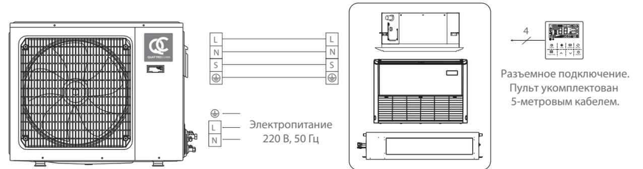
Электрическая схема QV-I48...60DGE/QN-I48...60UGE
