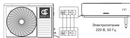
Электрическая схема QN-M18...24WBE/QV-M18...24WBE
