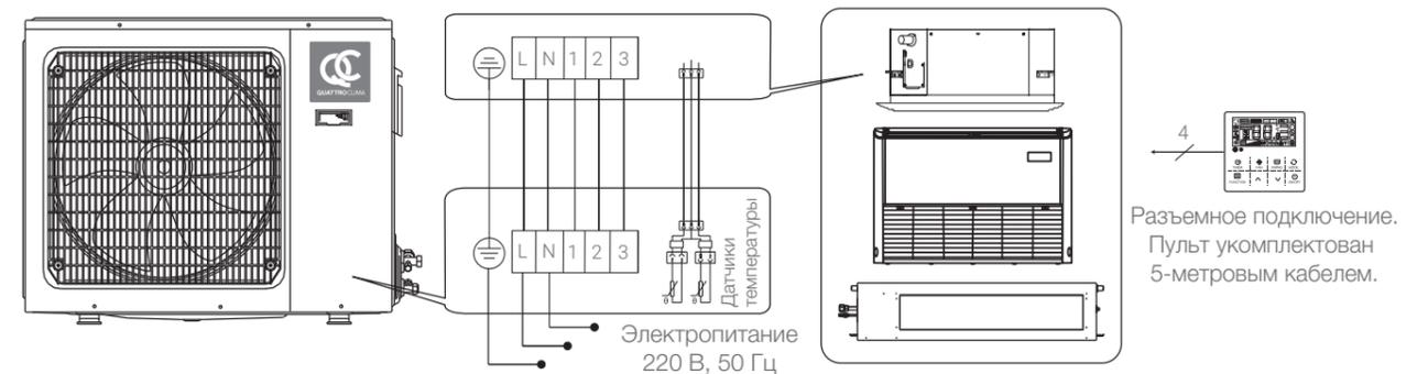
Электрическая схема QV-I36DG1/QN-I36UG1; QV-I48DG1/QN-I48UG1; QV-I60DG1/QN-I60UG1
