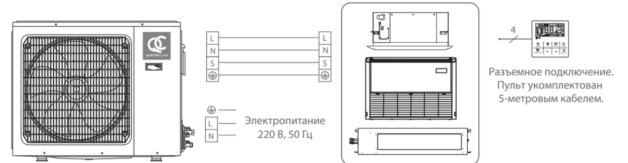
Электрическая схема QV-I48...60CGE/QN-I48...60UGE
