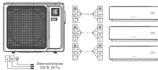
Электрическая схема подключения
