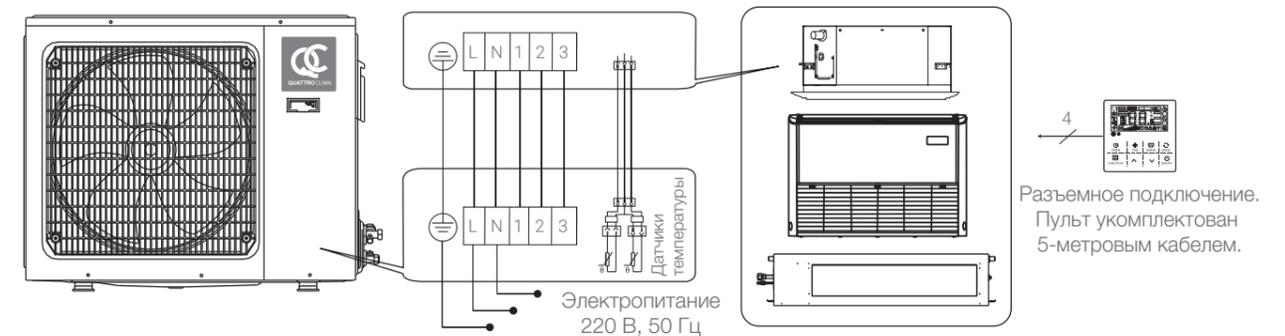
Электрическая схема QV-I36CG1/QN-I36UG1; QV-I48CG1/QN-I48UG1; QV-I60CG1/QN-I60UG1
