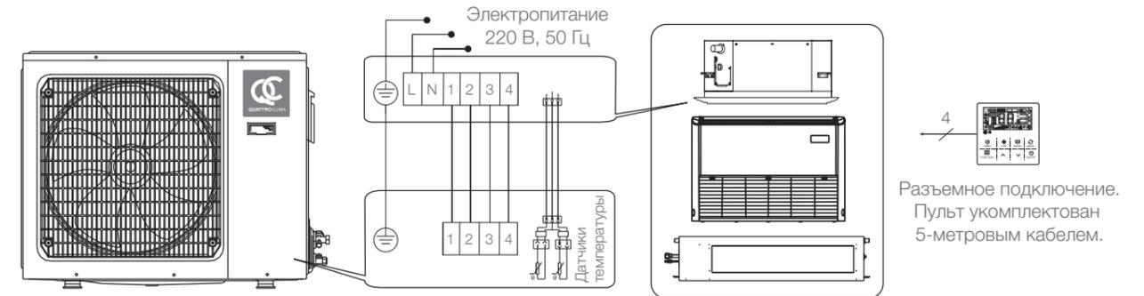
Электрическая схема QV-I24CG1/QN-I24UG1
